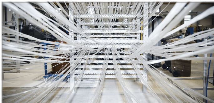
Abb. 1: Faserführung bei der Pultrusion am Schöck Standort in Halle (Saale)
